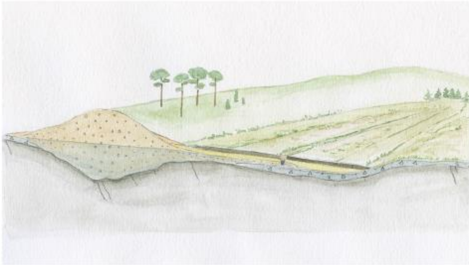
Figur 1. Illustration av ett typområde för våtmark i anslutning till ett åsmagasin 2 . Om dikningen är djup kan även åsmagasinet dräneras.
